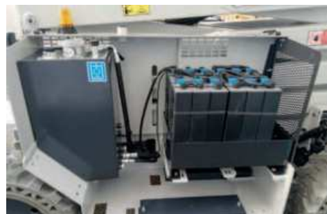
Druhý akumulátor a zásobník na naftu
