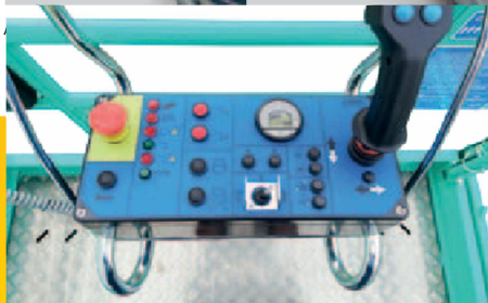
Jednoduchá a intuitivní ovládací skříň, kterou lze při nakládání/vykládání plošiny z koše vyjmout.
