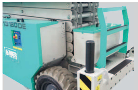
Druhý externí akumulátor u provedení DE
