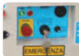
Pozemní ovládací panel umožňující intuitivní ovládání, dobře chráněný před náhodnými nárazy.
