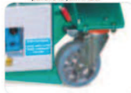
Blokování otočného kola pro přímý pojezd
