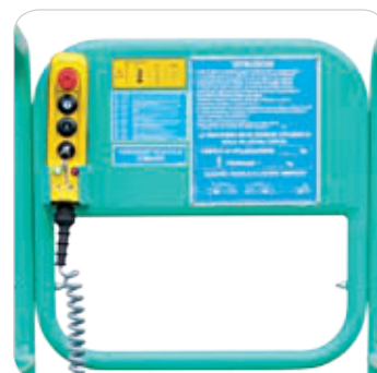
Snímatelný ovladač umožňuje snadný a bezpečný pohyb. Vybaveno spínačem na klíč a tlačítkem nouzového vypnutí.
